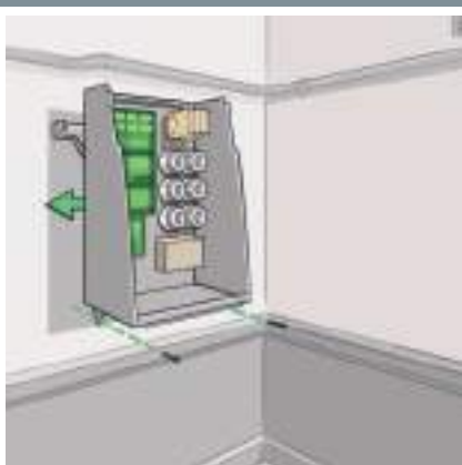
2. Agganciare ed avvitare il case con le viti alla base dell'unità
